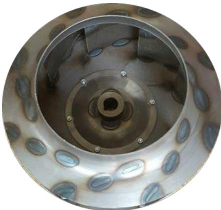
**Abbildung 15: Im Rahmen der Präsentation des QIB-Projektes C5 gezeigtes Bauteil mit sehr vielen WEZ (Quelle: Bader Pulverbeschichtung GmbH)**
