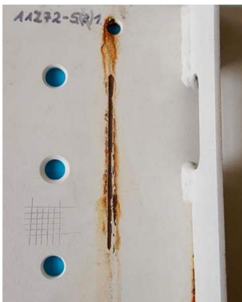
**Abbildung 20: Detailansicht einer Probe, die die aktuell gültigen Normanforderungen einer C5 Korrosivitätskategorie erfüllt. Im Spalt sichtbare Korrosion könnte noch durch eine zusätzliche Abdichtung vermieden werden**
