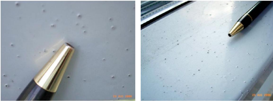
Im Zusammenhang mit den verwendeten Stahlsorten kommt es beim Aufwachsen der Zinkschicht auf dem Grundmaterial zu Störungen in Form von kleinen Hohlräumen, die beim Einbrennen des Pulverlackes Krater erzeugen können.
