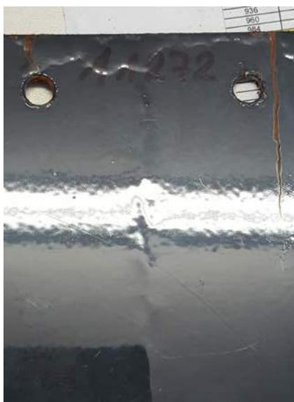
**Abbildung 17: Korrosionsprobleme am Kantenbereich aufgrund nicht vorbereiteter Kanten**
