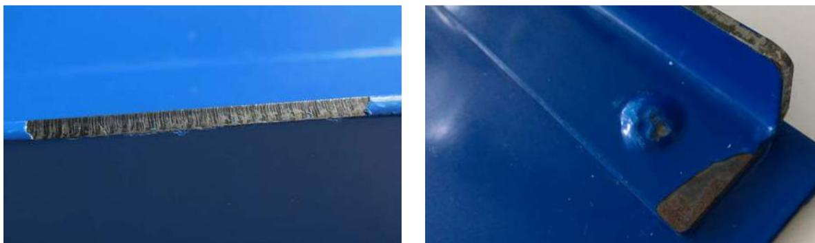
**Abbildung 16: unbearbeitete Laserschnittkanten mit Korrosions- und Haftungsstörungen. Die Einschnitte des Lasers sind gut zu erkennen. Sich bildende Oxidschichten sind teilweise schwer durch chemische Vorbehandlungen zu entfernen. Mit Schutzgas arbeitende Lasersysteme können die Situation verbessern.**
